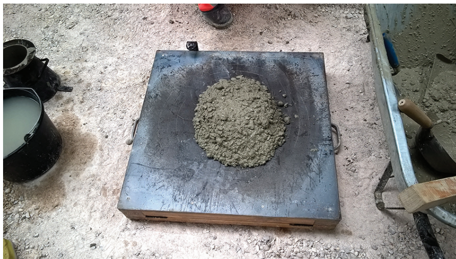
1. kép: Túl sűrű beton – F2 konzisztencia-osztályba tartozik. (fotó: Betonmix Kft.)
