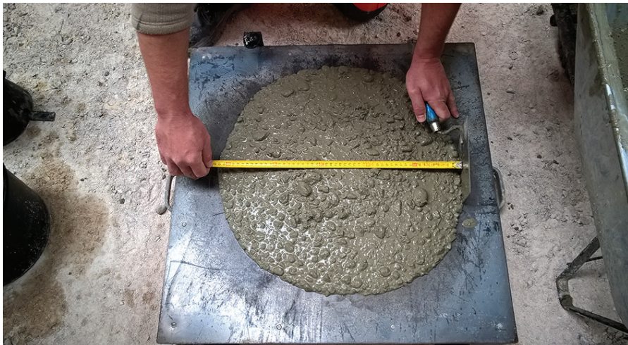
2. kép: Túl híg beton – F4 konzisztencia-osztályba tartozik. (fotó: Betonmix Kft.)
