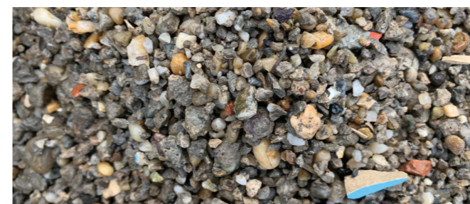
Vasbeton versenymedence bontási anyaga – újrahaznosított adalékanyag
