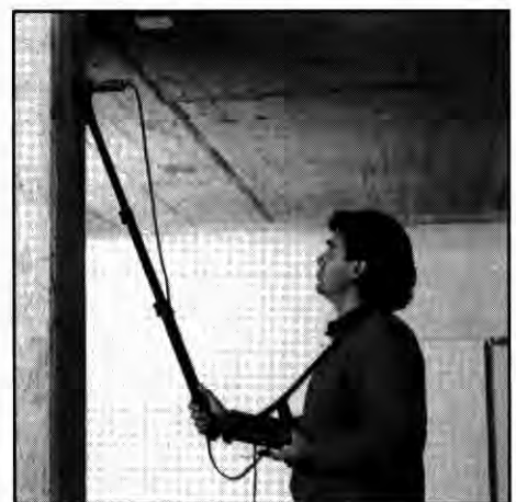
3. ábra Mérés rúdelektrodos fejjel
