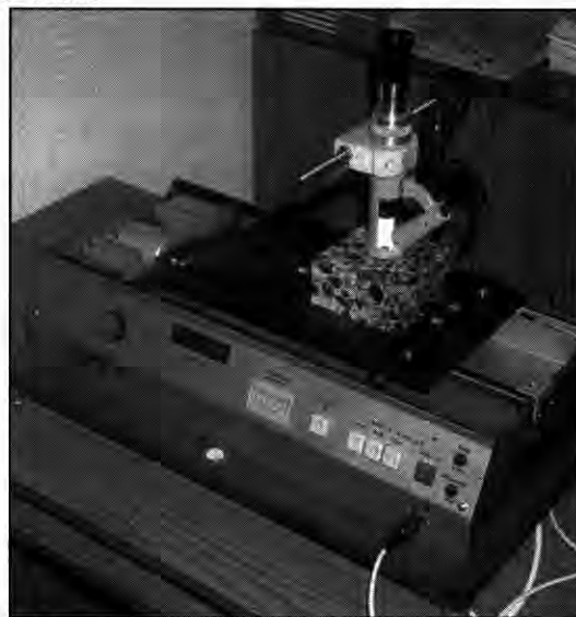
Optikai berendezés a póruseloszlás mérésére (SZIKKTI fényképfelvétel)
