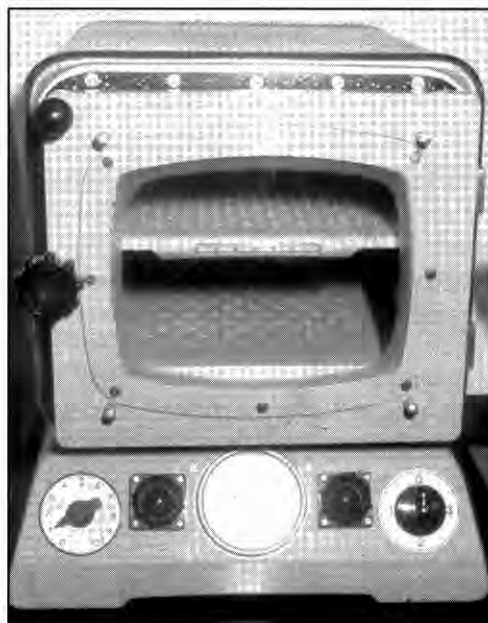
Vákuum szárítószekrény az elgőzölhető víz eltávolításához (SZIKKTI fényképfelvétel)
