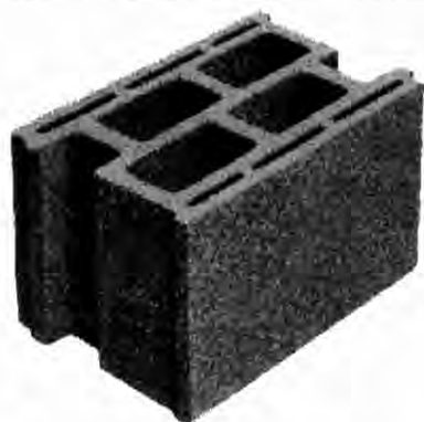
1. ábra Duzzasztott agyagkavics adalékanyagú, nagy-hézagterfogatú betonból készített főfal-falazóelem
