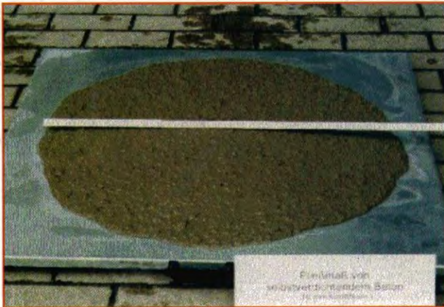
öntömörödő (SCC) beton
