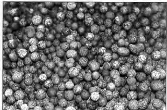
1. ábra Duzzasztott agyagkavics, szem nagysága 6/10 \text{ mm}
