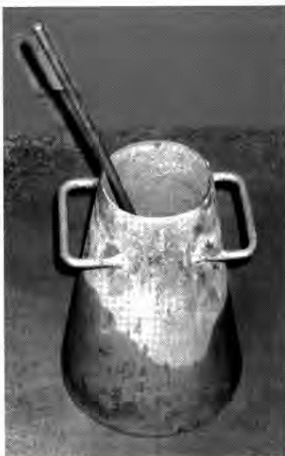
2. ábra Roskadás mérő csonkakúp
